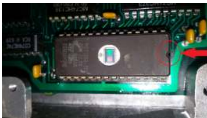
Fig.1 Riferimento per la sostituzione della EPROM con il kit Mr. Hide - Delta S4
