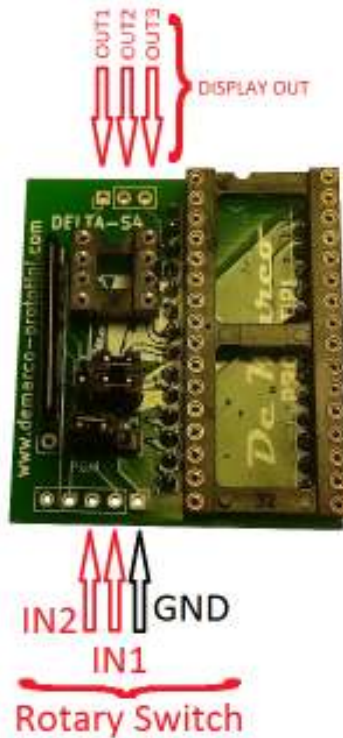
Fig.6 Riferimento per il collegamento interruttore e Display Mappa per kit Mr. Hide - Delta S4
